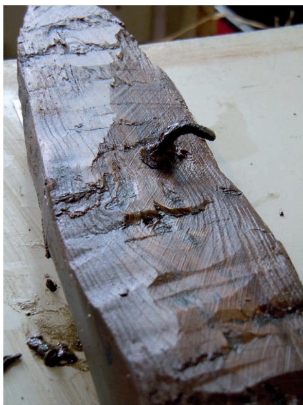
Afb. 9.2 Houten paal (vnr. 219) van fijnspar/lariks met spijker in punt (Foto: BIAX Consult).
